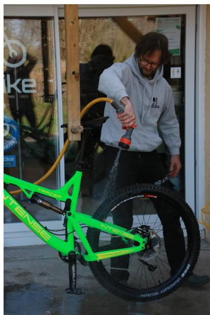
**Quand les premières étapes sont bien réalisées, le rinçage final se fait par simple douchage (verticalement, jamais dans l'axe des points de pivot)**
